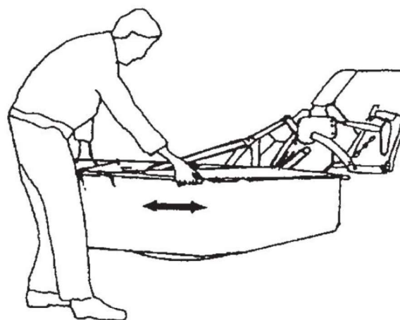
Rys. 9. Sposób obrotu kosiarki w czasie zmiany położenia z transportowego w robocze i odwrotnie.
